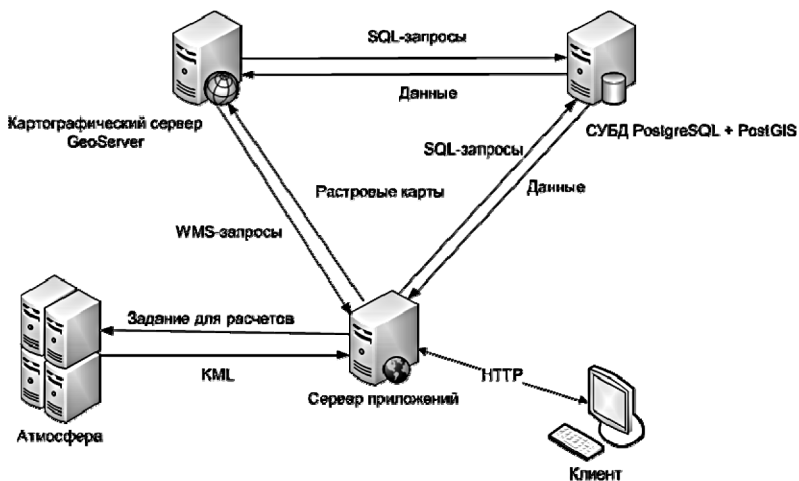
Рис. 1 Архитектура Интегрированной информационно-вычислительной системы для динамической оценки экологического состояния угледобывающего района (ИИВС ДОЭС)
